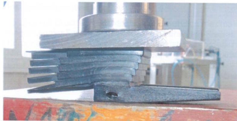
Abbildung 3: stark deformierter Montagekeil kurz vor dem Ende der Prüfung
